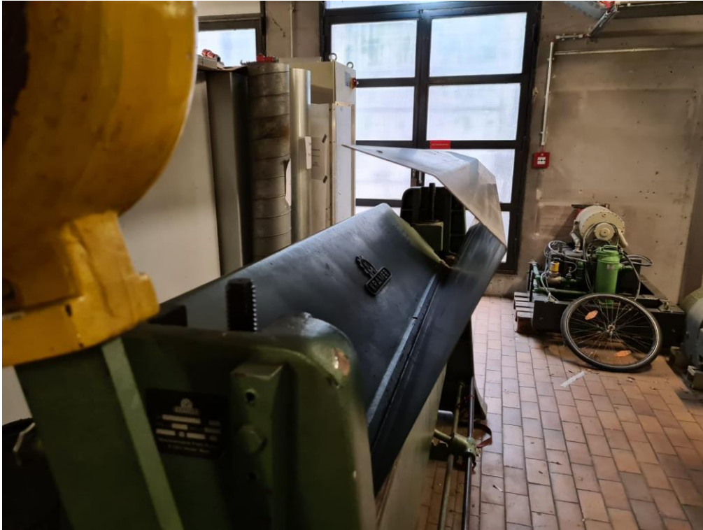
Abbildung 8: Biegeprozess des Korpusblechs
