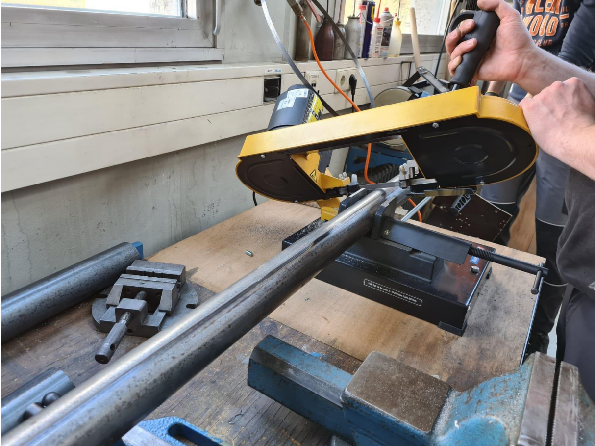
Abbildung 3: Einsatz Bandsäge bei Rundrohr
