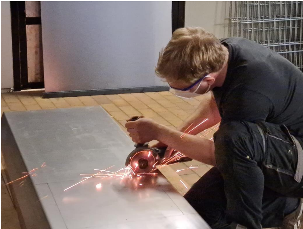
Abbildung 9: Aussägen Lade Boxen mit Handwinkelschleifer
