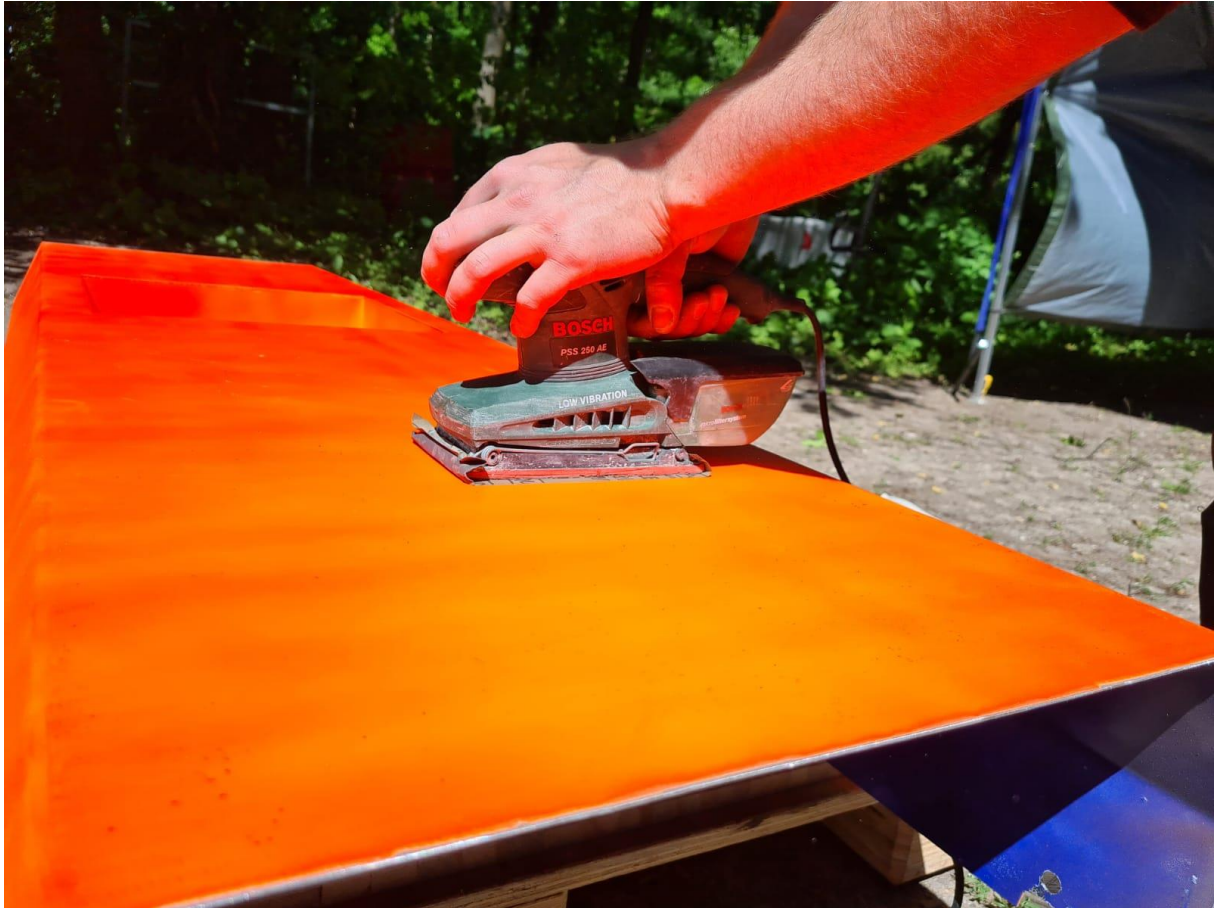
Abbildung 14: Aufrauen der Oberfläche
