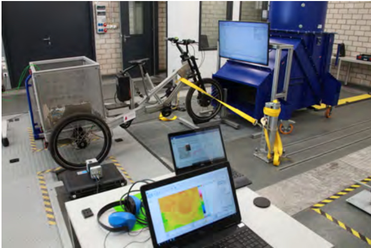
Abbildung 9. Versuchsaufbau mit E-Rikscha und Wärmebildkamera.
