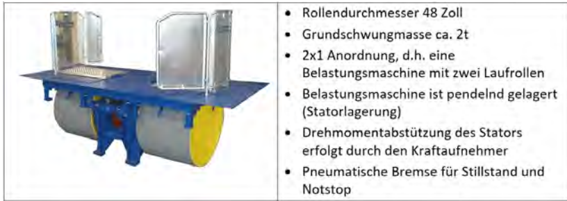
Abbildung 3. AVL Roadsim Scheitelrollenprüfstand (Foto: AVL) mit technischen Daten.
