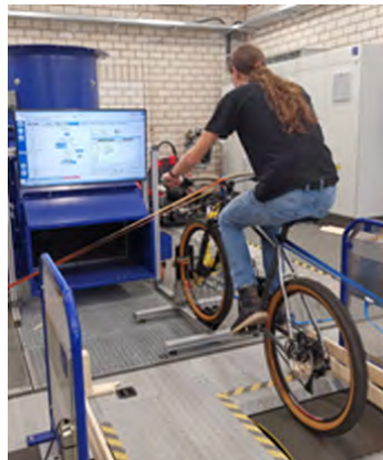
Abbildung 1. Messung mit einem Fahrrad auf dem Rollenprüfstand
