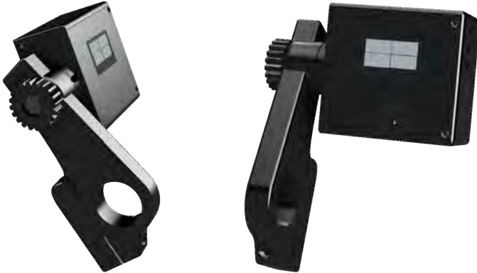
Abbildung 7: Gehäuse mit der zugehörigen Lenkerhalterung als 3D-Modell aus verschiedenen Perspektiven
