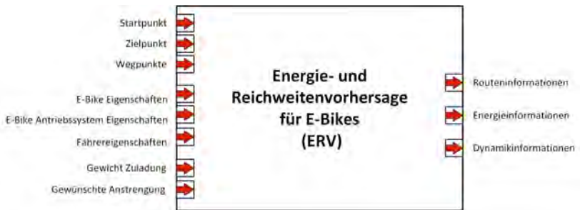
Abbildung 2: Blackbox des Algorithmus zur Energie- und Reichweitenvorhersage für E-Bikes
