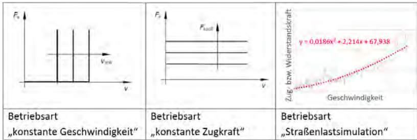
Abbildung 4. Neben den klassischen Betriebsmodi v = \text{konst.} und F = \text{konst.} , bietet der AVL Prüfstand die Möglichkeit einer Straßenlastsimulation
