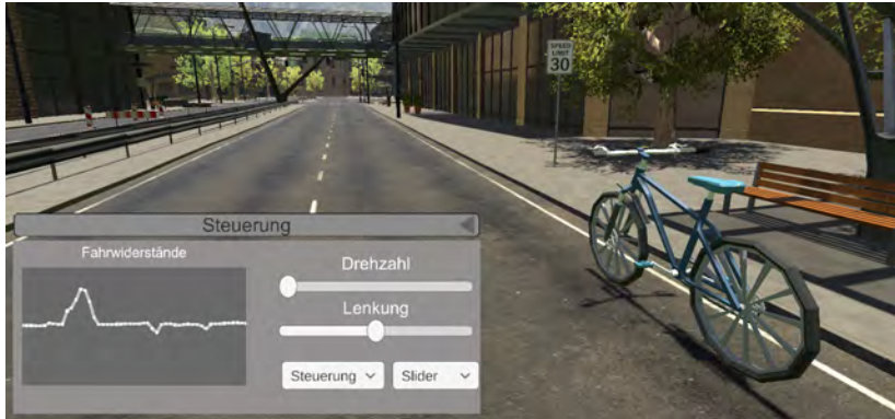
Abbildung 6. Das virtuelle Fahrrad in der Simulationsumgebung Windridge City . Ebenfalls dargestellt wird die Steuerung und das Diagramm, welches Informationen über Fahrwiderstände liefert. Die Steuerung des Fahrrads kann dabei, wie beispielsweise hier dargestellt, manuell mit Slidern erfolgen oder über das Simulatorfahrrad.
