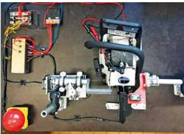
Abb. 5: Die von der Karlsruher Gruppe entwickelte Fernbedienung für Motorgeräte; Foto: Hochschule Karlsruhe
