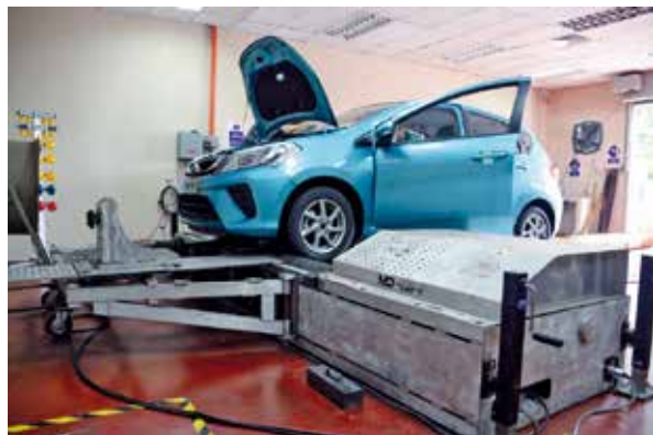
Abb. 7: Über das Internet und das Fahrroboter-System „Gasfuß“ ferngesteuertes Fahrzeug auf dem Rollenprüfstand im UMP-Labor; Foto: Hochschule Karlsruhe
