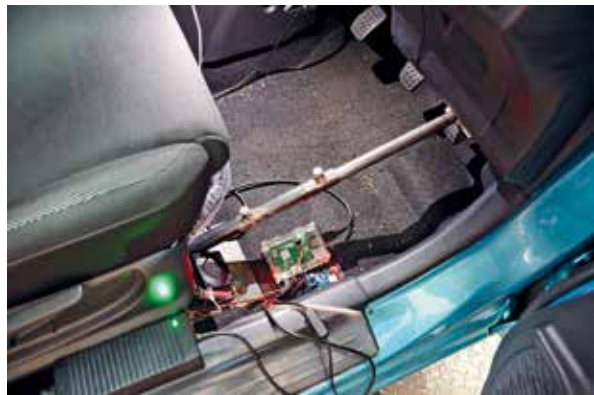
Abb. 6: Von der malaysischen Gruppe entwickeltes Fahrroboter-System „Gasfuß“ für Fahrzeuguntersuchungen auf einem Rollenprüfstand; Foto: Hochschule Karlsruhe
