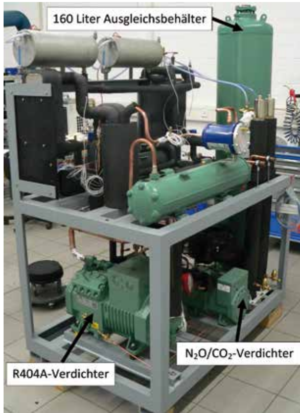
Abb. 1: Versuchsanlage für das N 2 O/CO 2 -Kältemittelgemisch
