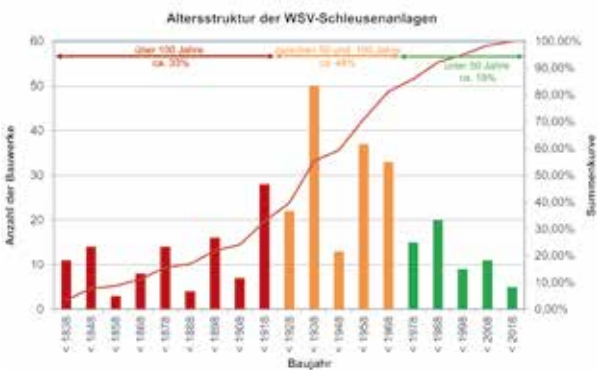
Abb. 1: Altersstruktur der Schleusenanlagen der WSV
