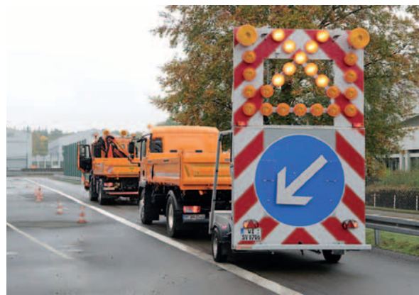
Abb. 2: Fahrerlos fahrendes Absicherungsfahrzeug (AFA) auf dem Testgelände der Bundesanstalt für Straßenwesen (BAST) im Oktober 2016 (Foto: Tim Reuber)
