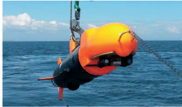
Abb. 4: Sensorsystem im Lastkopf eines unbemannten Unterwasserfahrzeugs (SeeKatze der Firma ATLAS ELEKTRONIK GmbH); links im Detail, rechts beim Einsatz (Fotos: Peter Rabenecker)
