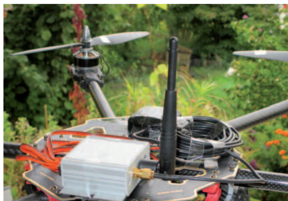
Abb. 4: NAVKA Flight-Control Box NAVKArine-FC4 (links) (Foto: J. Zwiener); NAVKA Klein-UAV mit NAVKArine-FC4 Box (rechts) (Foto: R. Jäger)
