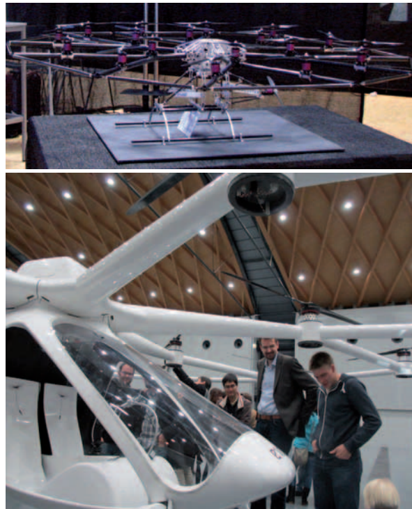
Abb. 5: UAV VC 25 (25 kg, 3 m, n = 18 Propeller) (oben); bemannter Multikopter VC 200 (Payload 450 kg, n = 18 Propeller) (unten) (Fotos: R. Jäger)
