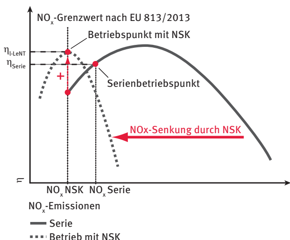
Abb. 1: Trade-off zwischen Wirkungsgrad und NO x -Emissionen (schematisch)
