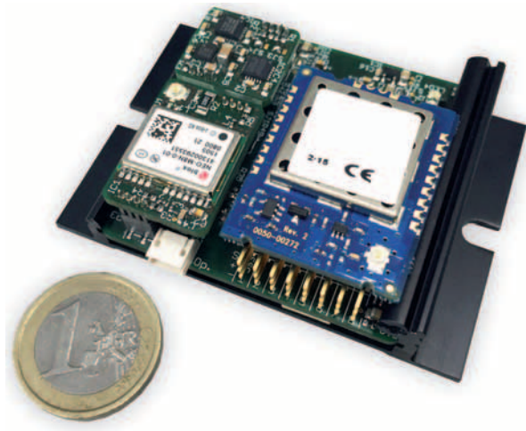
Abb. 4: NAVKA Flight-Control Box NAVKArine-FC4 (links) (Foto: J. Zwiener); NAVKA Klein-UAV mit NAVKArine-FC4 Box (rechts) (Foto: R. Jäger)
