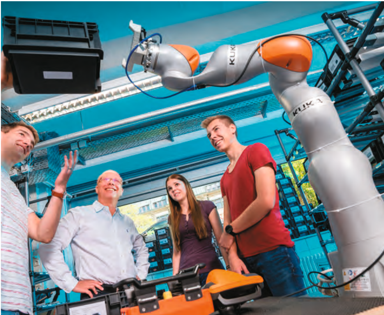
Abb. 1: Automatisierte Prozesslösung mit mobiler Plattform und kollaborativem Roboter (Cobot) für die Handhabung und den Transport mit Kleinladungsträgern (KLTs) in industriellen Logistikprozessen.
