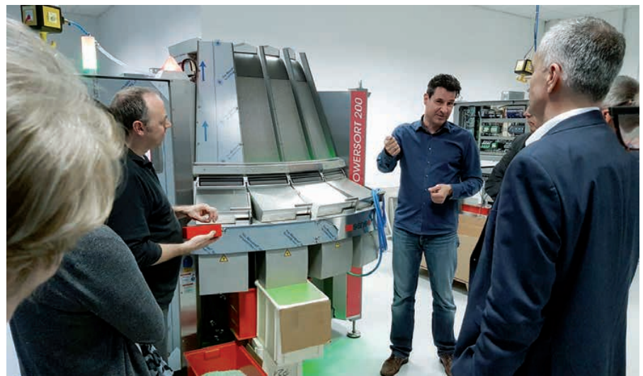
Anlage zur Sortierung von Kunststoffmüll
